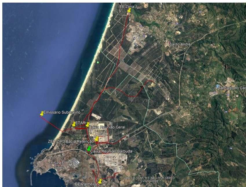
Figura 7 - Esquema do subsistema da água residual da AdSA, através de imagem de satélite pelo Google Earth®.
