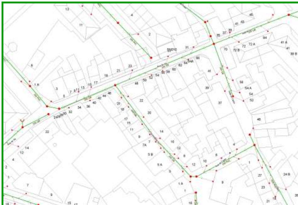
Figura 4 – Representação esquemática da rede de saneamento de águas residuais – troços coletores, ramais de ligação e respetivos números de polícia.
