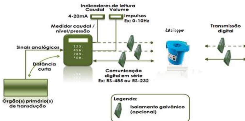
Figura 5: Diagrama funcional de uma solução de montagem com a função de um data logger.
